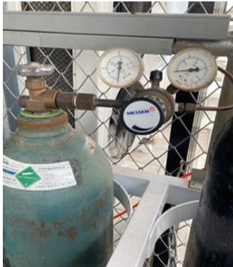
ภาพแสดงเกจวัดกำลังดันของถังก๊าซอาร์กอน
